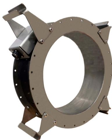
**7. Катушка намагничивания (магнитопорошковый дефектоскоп) КАЧЕСТВО- С300 «Буровой Макси» - 390 000 руб. с НДС.**
