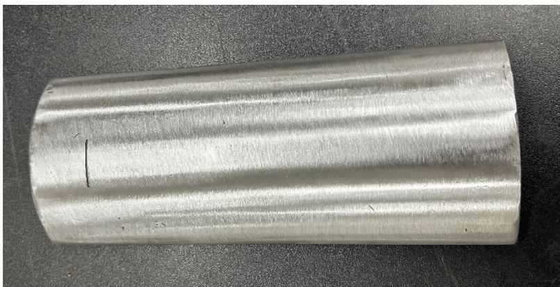
**3. Образец (УЗТ) для для проверки работоспособности толщиномеров (диаметр по выбору заказчика, преимущественно сталь 20 или по желанию заказчика сталь может изменена) – 9 000 руб. с НДС**
