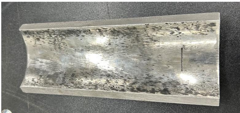
**2. Образец тело трубы (УЗД) для настройки и определения браковочной чувствительности, длительности развертки при ультразвуковой методе контроля (диаметр по выбору заказчика, преимущественно сталь 20 или по желанию заказчика сталь может изменена) – 16 000 руб. с НДС**
