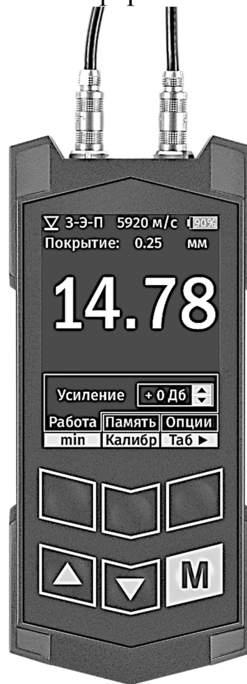
Рисунок 1. Внешний вид толщиномера БУЛАТ 3
