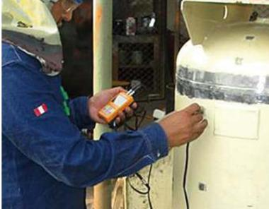
Ультразвуковой толщиномер CTS-30A/CTS-30B, использующий микропроцессорную технологию и усовершенствованный производственный процесс, может измерять толщину и скорость звука на металле и многих других материалах.
