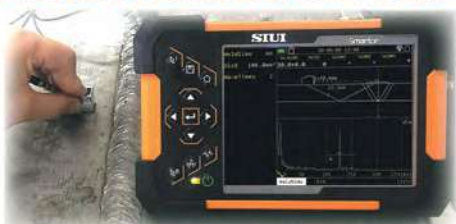
Динамическое отслеживание луча и визуализация расположения дефекта
