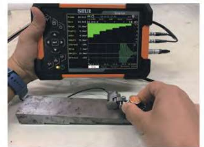
Запись В-скана с энкодером PES-02D
